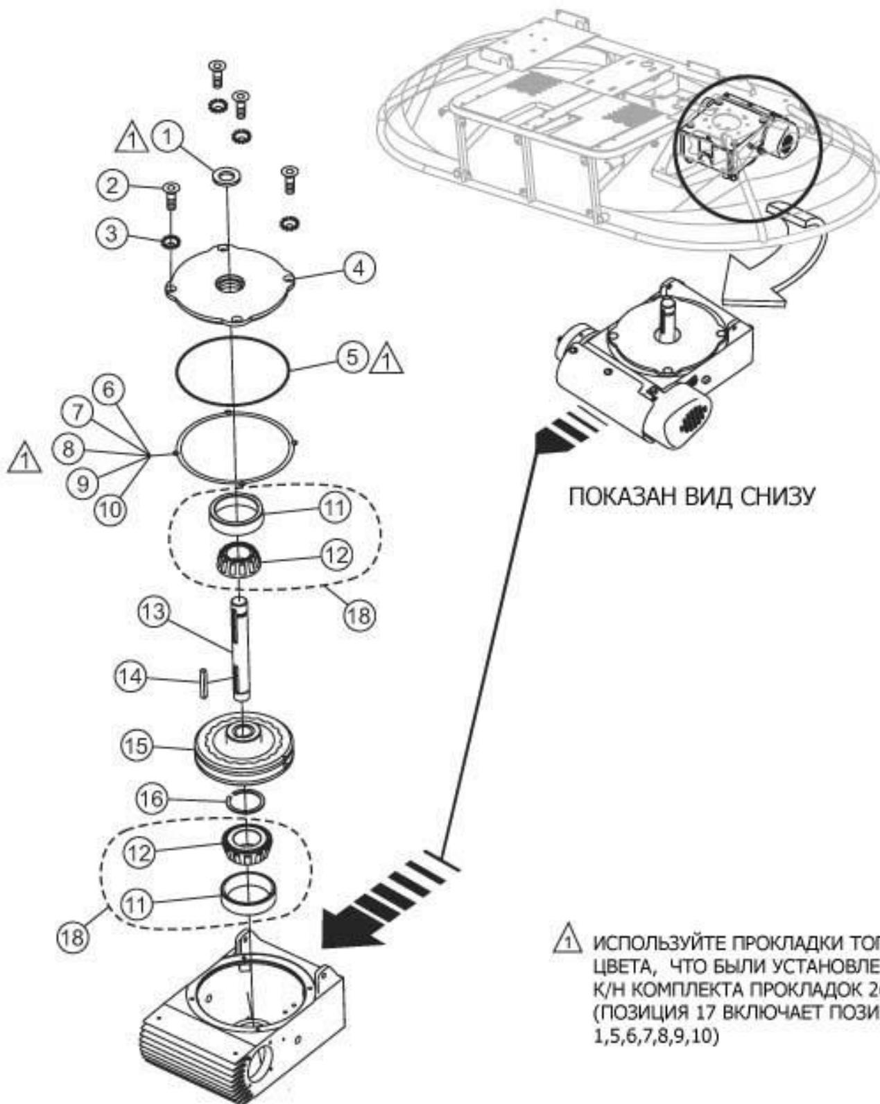
**ДВУХРОТОРНАЯ БЕТОНООТДЕЛОЧНАЯ МАШИНА WHITEMAN JWN24HTCSL****РЕДУКТОР ЛЕВЫЙ****Вид со стороны выходного вала**
